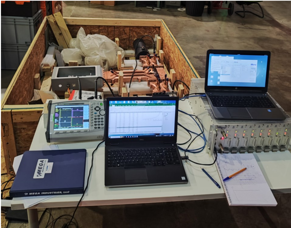
Figure 2 : Atténuateur MEGA Industries sous test
